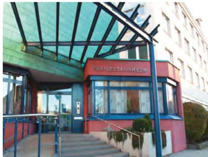
Massivbauweise aus Backsteinen, innen mit Leichtbauwänden, beheizbarer Windfang
